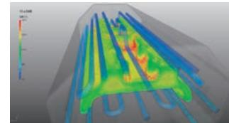
冷却水と金型間での熱伝導
